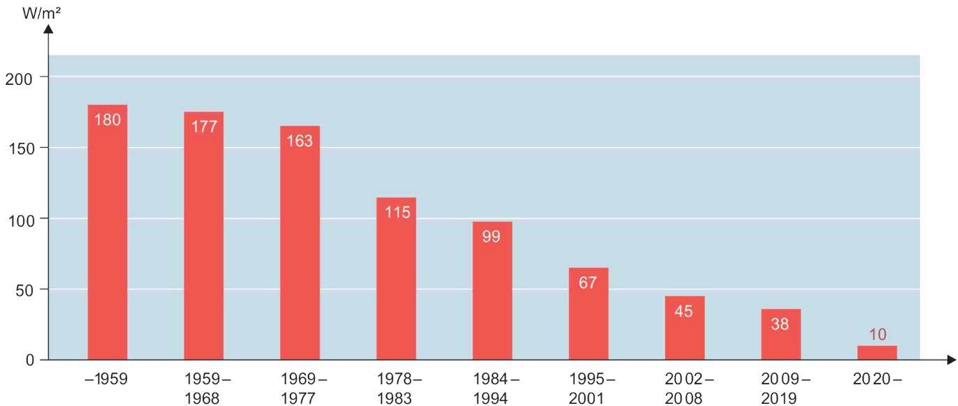
Zur überschlägigen Heizlastermittlung durch Baujahr und Wohnfläche wird der spezifische Heizleistungsbedarf für Gebäude gemäß Baujahr herangezogen. Bild: Wolf GmbH
