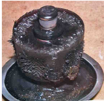
Auch massive Magnetitablagerungen durch schlechte Kreislaufwasserqualität gehören zu den Schadensbildern.
